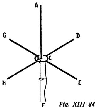
La partie rayonnante est constituée par la tige verticale AB; une terre fictive est obtenue par les quatre éléments CD, CE, CG et CH, disposés en croix dans un plan horizontal. Ces éléments, ainsi que le brin rayonnant, ont une longueur voisine de λ/4. Si on les confectionne en tube de cuivre de 10 mm de diamètre, on applique la formule suivante :
