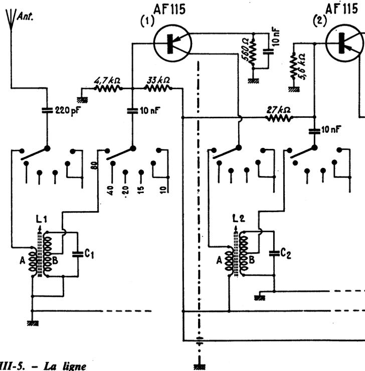
**Fig. VIII-5.** - La ligne partant du bas de la bobine  $L_3$  A doit être reliée en outre à la connexion d'alimentation (-9 V après l'interrupteur).
