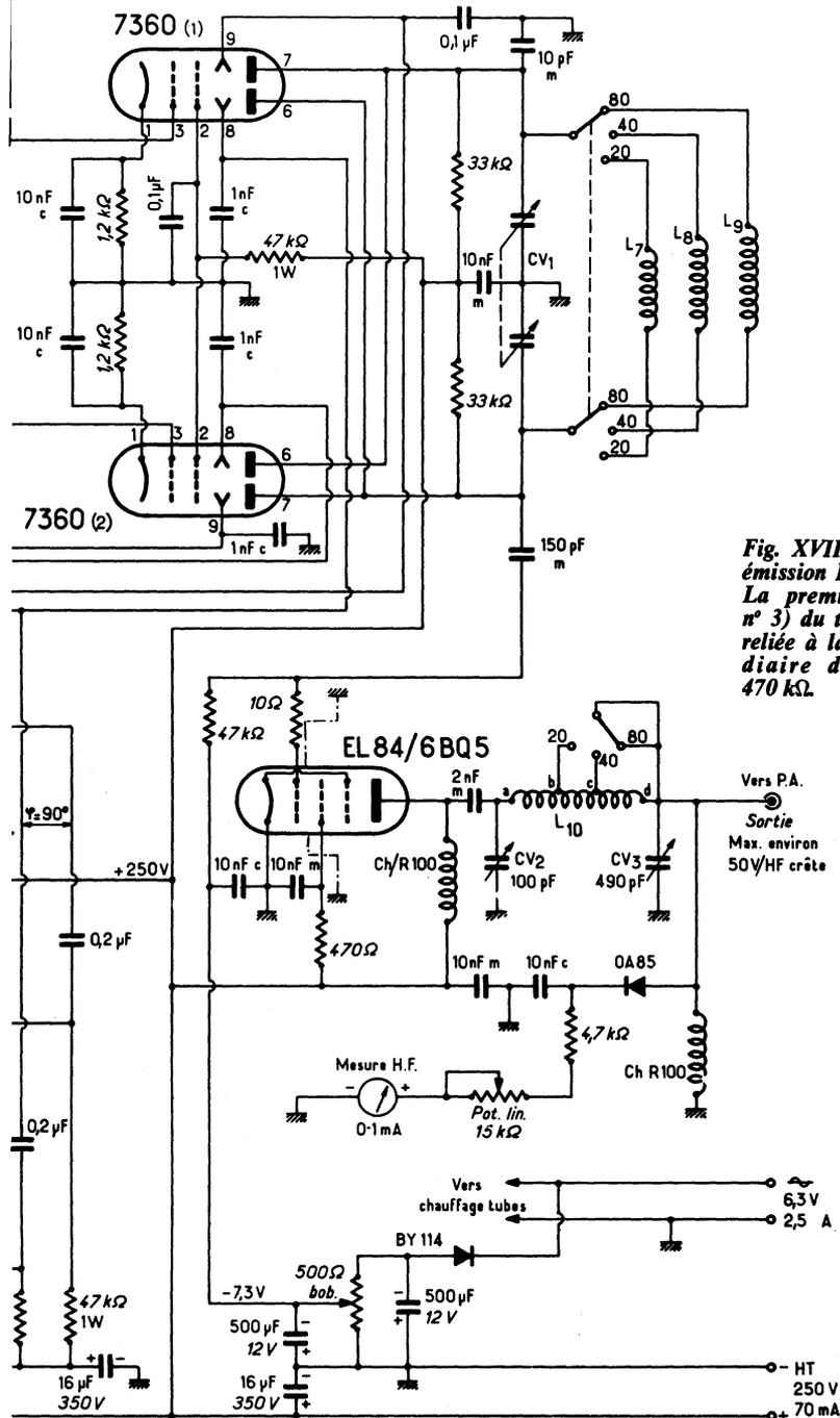
Fig. XVII-9. - Adaptateur pour émission B.L.U. (voir page 529). La première grille (électrode n° 3) du tube 7360 (2) doit être reliée à la masse par l'intermédiaire d'une résistance de 470 kΩ.
