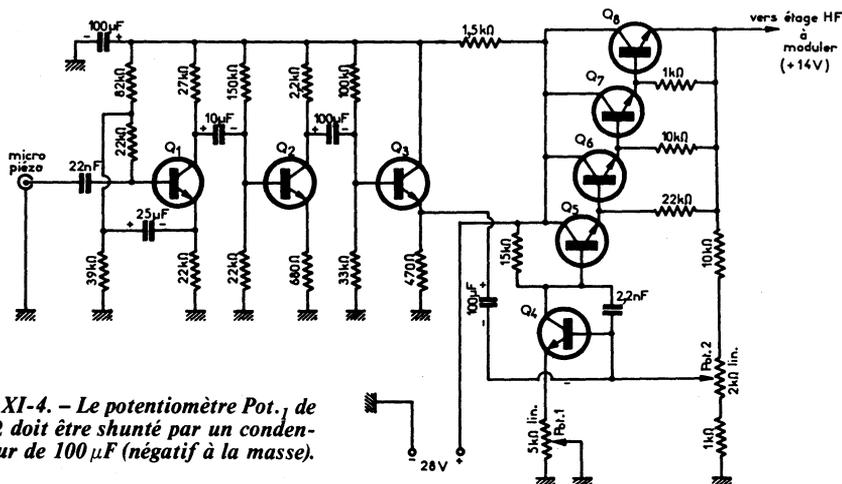
Fig. XI-4. — Le potentiomètre Pot.<sub>1</sub> de 5 kΩ doit être shunté par un condensateur de 100 µF (négatif à la masse).
