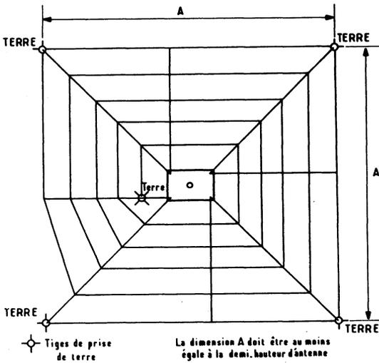
La dimension A doit être au moins égale à la demi-hauteur d'antenne
