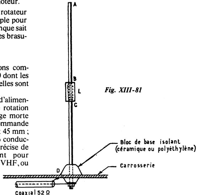
comporte au total 60 tours de fil de cuivre argenté de 12/10 de mm enroulés sur un tube de carton bakélinisé de 70 mm de diamètre ; longueur totale de l'enroulement :
