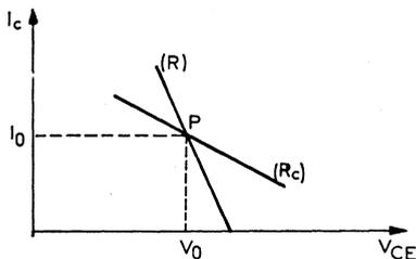
dynamique ( $R_c$ ) dans le quadrant des caractéristiques  $I_c$ ,  $V_{CE}$ . Le point de fonctionnement moyen P est fixé par les valeurs des grandeurs continues  $V_0$  et  $I_0$ . Cette tension et cette intensité sont étroitement liées ; on peut donc arbitrairement choisir le régime du transistor en maintenant constant, soit  $I_0$ , soit  $I_B$ , soit  $V_{BE}$ . On a donc le choix entre deux modes de polarisation en courant continu :
