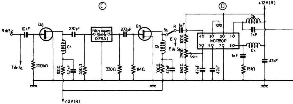
La figure XVII-29 représente le filtre à quartz 9 MHz (type XF 9 A) suivi de l'amplificateur M.F. 9 MHz (C et D). Pour compenser la perte d'insertion, le filtre à quartz est encadré par les transistors Q<sub>8</sub> et Q<sub>9</sub>, et une sélectivité parfaite est ainsi obtenue.
