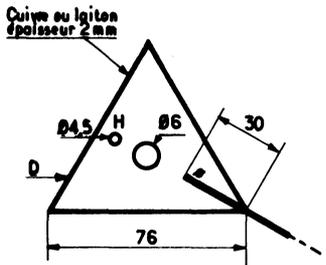
trou central de 6 mm seulement, doit être façonnée d'après les indications de la figure XIII-91 ; le trou H est destiné à recevoir un boulon de 4 mm pour la fixation de l'autre branche du stub.
