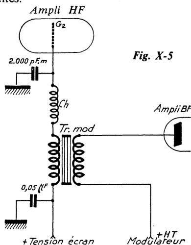
$V_{g2}$  est donc choisi inférieur à la valeur habituelle ; sinon, en crête, la tension instantanée d'écran étant plus élevée que la tension instantanée de plaque (qui passe précisément, à ce moment, par sa valeur la plus faible), la plupart des électrons arriveraient sur l'écran, au détriment de l'anode et de son courant. Il en résulterait une dissipation exagérée de l'écran et un affaiblissement notable de la puissance utile de sortie.
