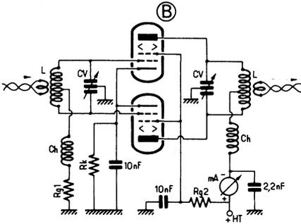
c) Un étage comportant deux lampes en *push-pull* (étage symétrique) peut avoir son circuit anodique accordé sur la fréquence fondamentale d'excitation et sur tous les harmoniques impairs :  $F$ ,  $3F$ ,  $5F$ , etc. (fig. V-24-B).
