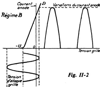
La puissance obtenue dans l'anode est proportionnelle au carré de la tension appliquée sur la grille de commande. Le régime B s'obtient en faisant la polarisation négative de grille  $-U$  égale à la polarisation de blocage pour la tension d'alimentation continue d'anode considérée ; en
