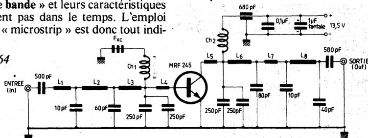
qué sur circuit imprimé et leur impédance caractéristique peut être choisie par simple modification des dimensions.
