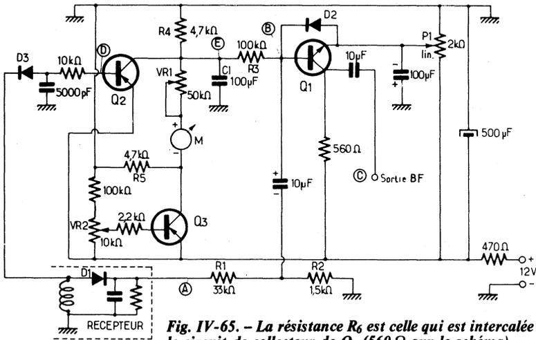
Fig. IV-65. — La résistance  $R_6$  est celle qui est intercalée dans le circuit de collecteur de  $Q_1$  ( $560 \Omega$  sur le schéma).
