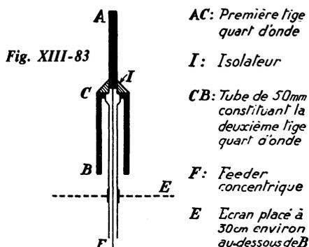
Le doublet est constitué par une tige AC quart d'onde supportée par un isolateur I; ce dernier supporte un autre quart d'onde, C B, constitué par un tube de 50 mm de diamètre.
